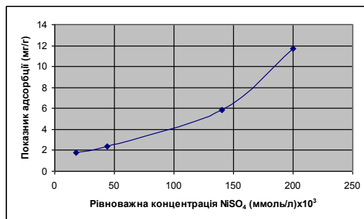
Рисунок 1 – Ізотерма адсорбції йонів \text{Ni}^{2+} на глинистому сорбенті
